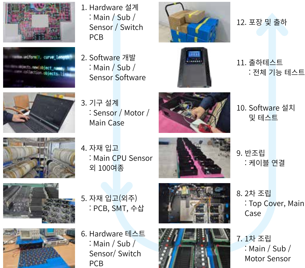
[그림 12] 환경장치 제조 공정
